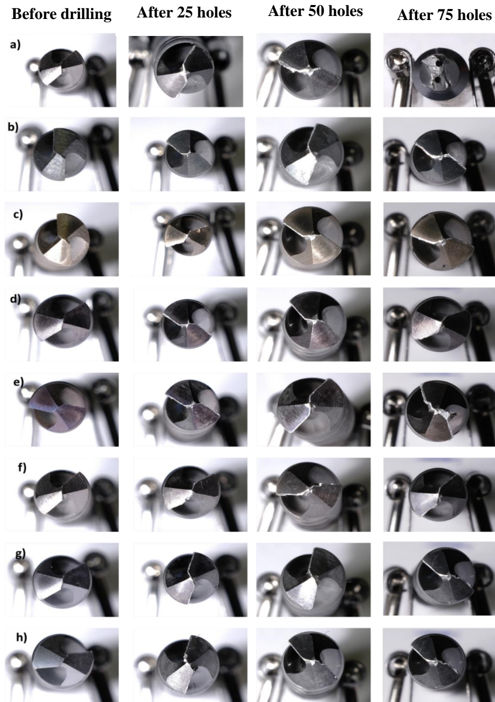
Figure 63. High resolution macro-objective images of a) Al_{67}Ti_{33} , b) Al_{64}Cr_{36} , c) Al_{50}Ti_{50}W-1 , d) Al_{50}Ti_{50}W-2 , e) Al_{67}Ti_{33}-Mo-1 , f) Al_{64}Cr_{36}-Mo-1 , g) Al_{67}Ti_{33}-Mo-2 , and h) Al_{64}Cr_{36}-Mo-2 .
